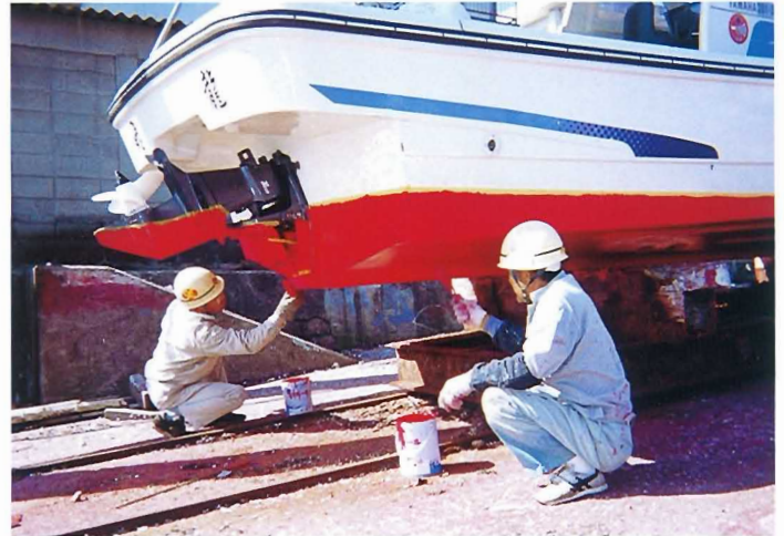
■船底塗装作業
